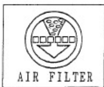
Засор воздушного фильтра
