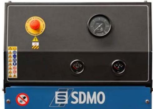
Пульт M80 имеет двойное назначение. Он служит обычной контактной платой для соединения электрошкафа и щитка приборов, чьи инструменты позволяют отслеживать путем прямого считывания основных параметров вашего электроагрегата.
