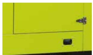
Отверстия для топливных трубопроводов
